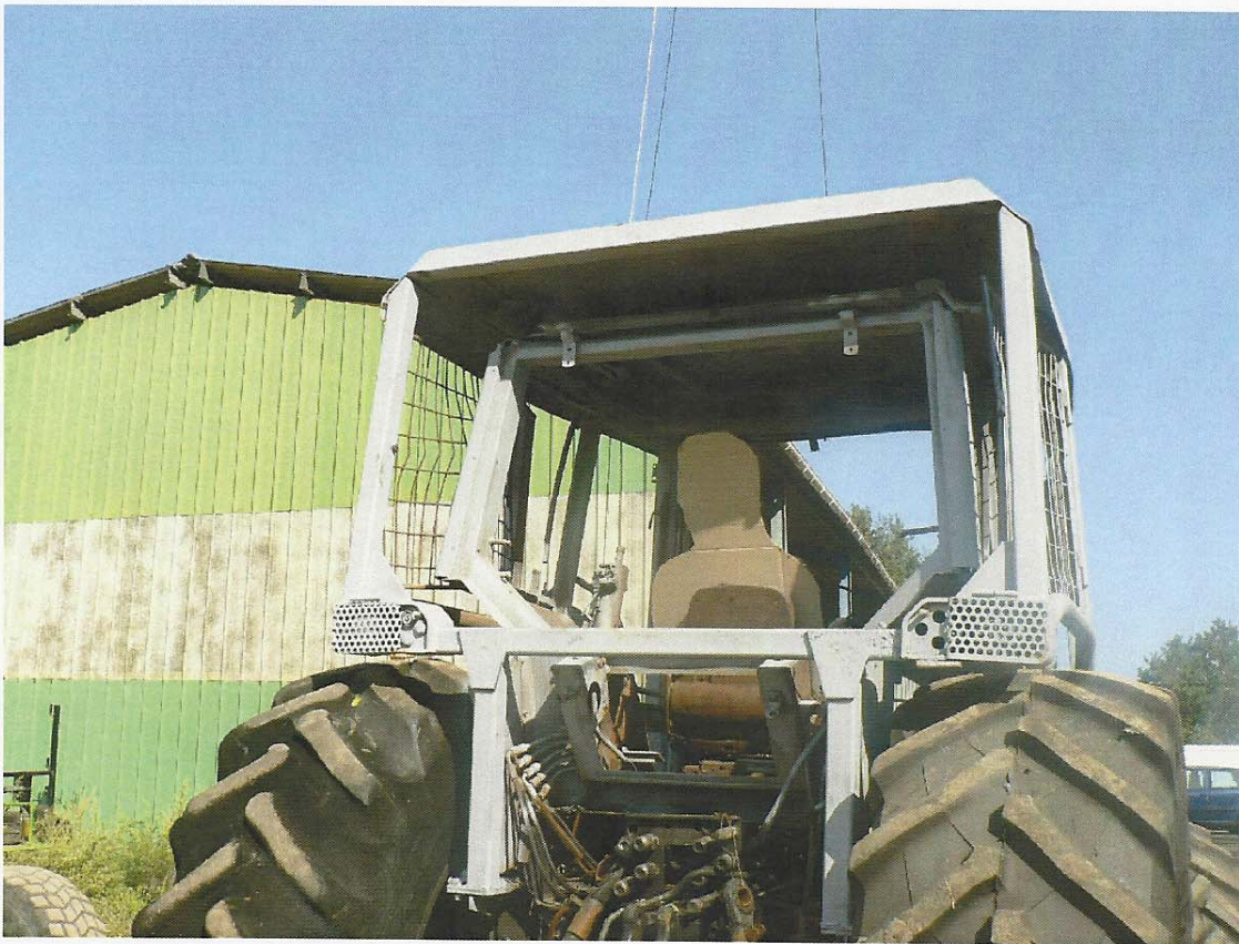
Déformation maximale au pont d'impact 130 mm
