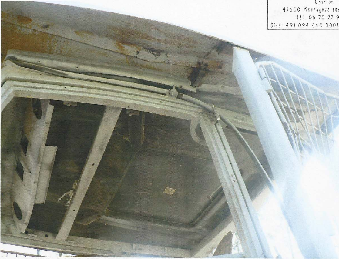
Déformation maximale au pont d'impact 130 mm
